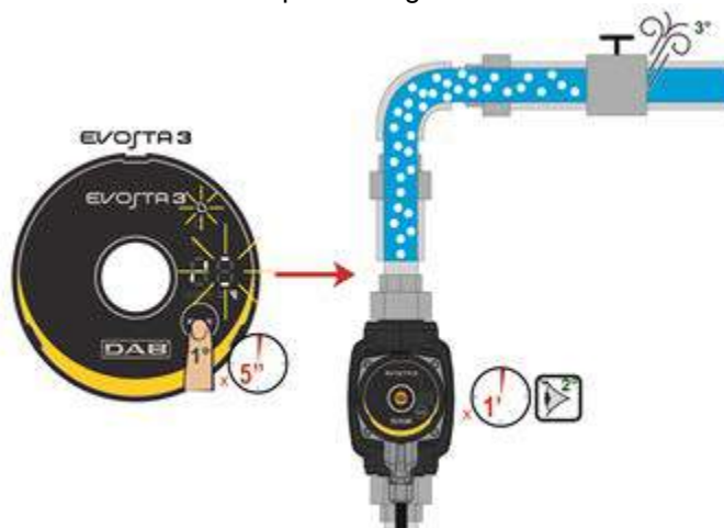
Figura 9: Drenagem automática da bomba
