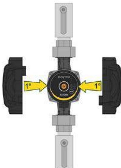
Figura 7: Izolare corp pompa
