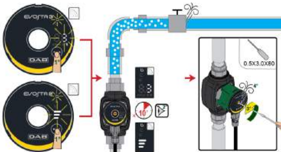
Obrázek 8: Odvzdušnění čerpadla
