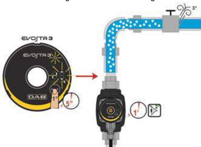
Fig 9: Automatisk avluftning av pumpen
