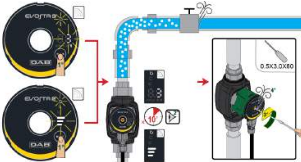
Joonis 8: Pumba õhutustamine
