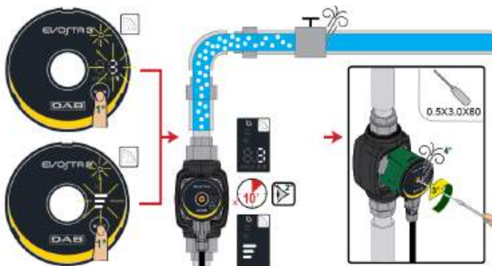
Рисунок 8: Удаление воздуха из насоса
