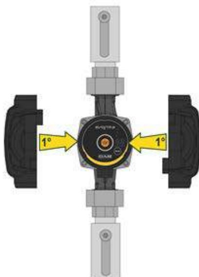
Figura 7: Isolamento do corpo da bomba
