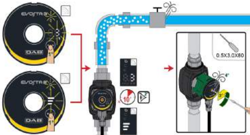
Figura 8: Drenagem da bomba
