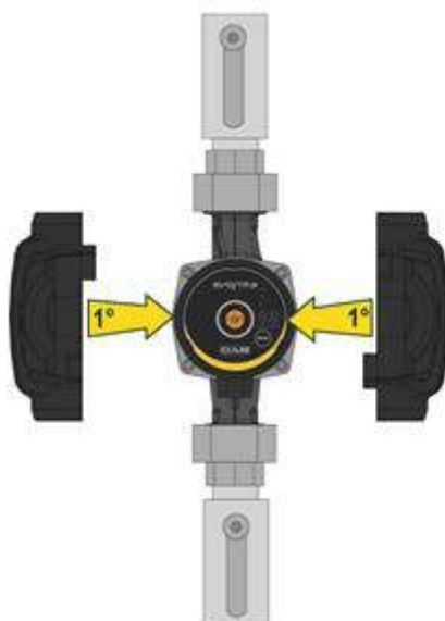
Image 7: Isolation du corps de pompe
