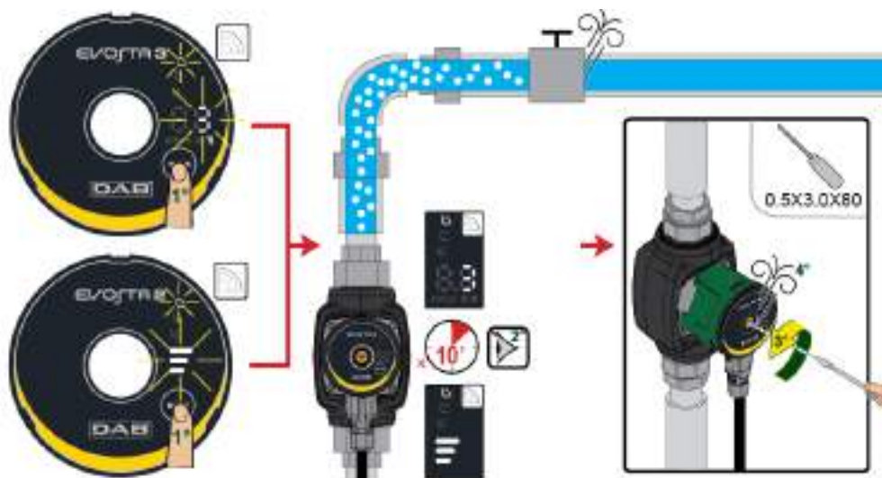
Figura 8: Sfiato della pompa
