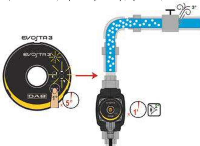
Rysunek 9: Automatyczne odgazowanie pompy
