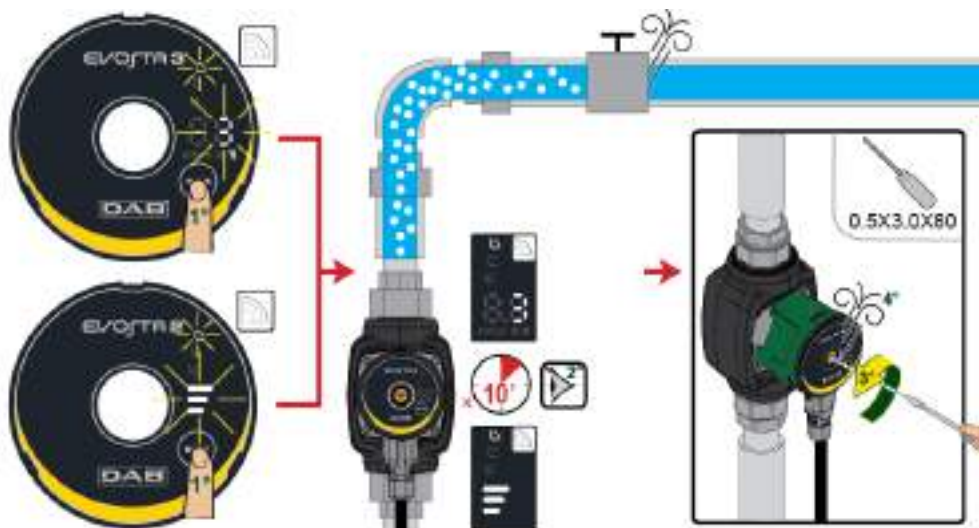
Slika 8: Odzračitev črpalke
