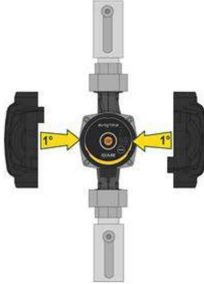
Resim 7: Pompa gövdesinin yalıtımı
