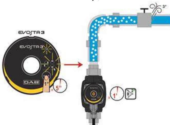
Slika 9: Avtomatska odzračitev črpalke
