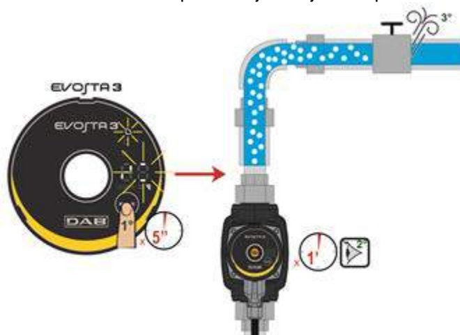
Kuva 9: Pumpun automaattinen ilmaus
