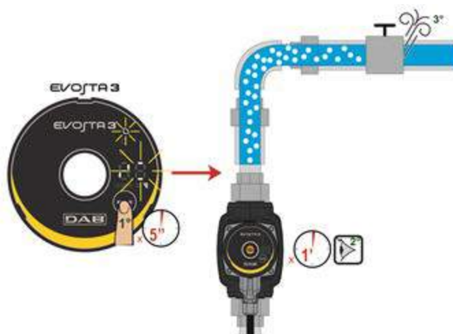
Рисунок 9: Автоматическое удаление воздуха из насоса
