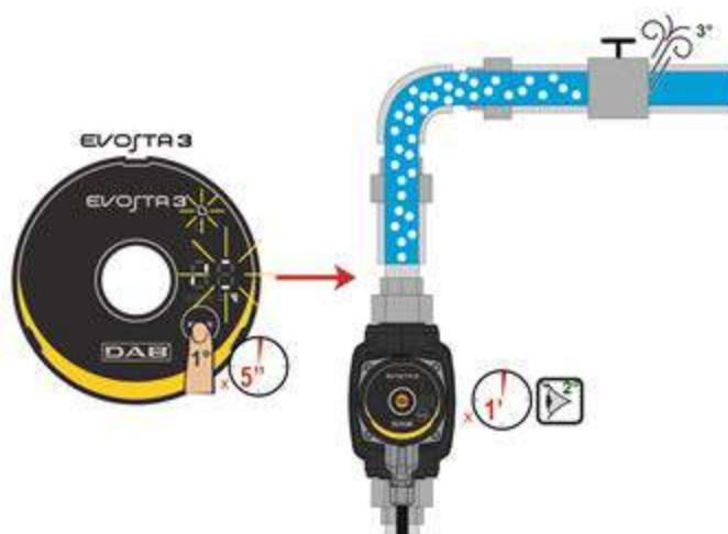
Figura 7: Purga automática de la bomba
