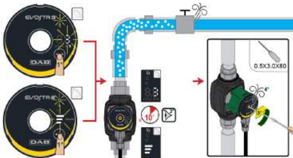
Fig 8: Avluftning av pumpen
