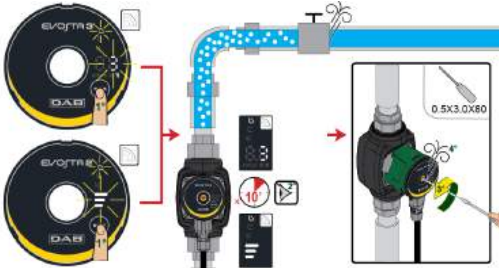
Afbeelding 8: Ontluchting van de pomp
