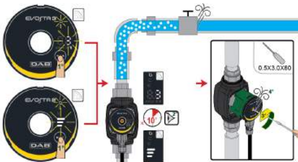
Obrázok 8: Odvzdušnenie čerpadla
