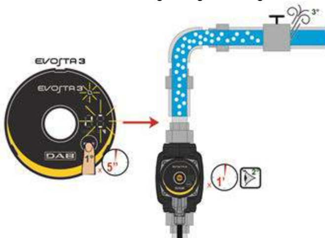
Fig. 9: Automatisk udluftning af pumpe
